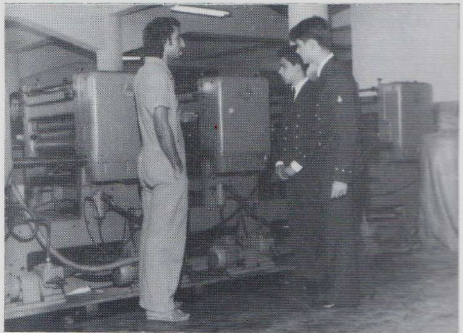
Moderna máquina «off-set», capaz de imprimir quatro cores distintas
