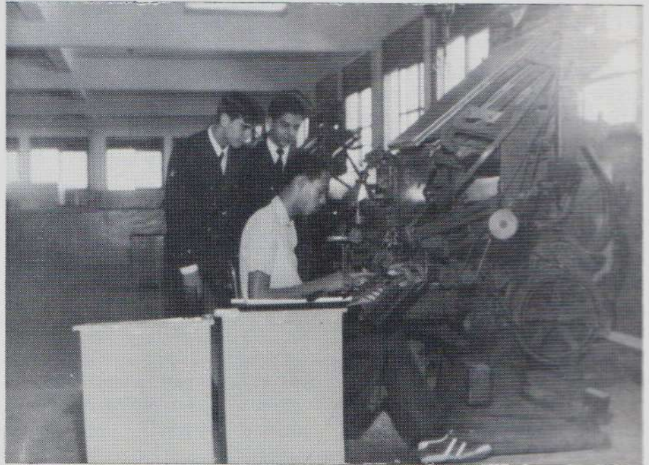
Máquina Linotipo, com o operador acionando suas teclas
