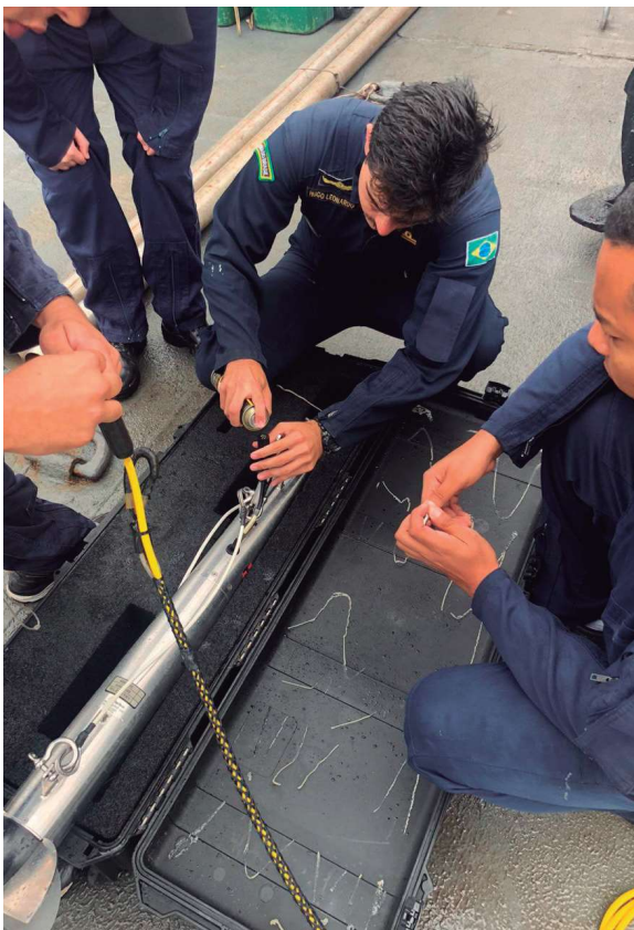
Figura 2 – LHFC 2019 - Montagem do Sonar de Varredura Lateral
