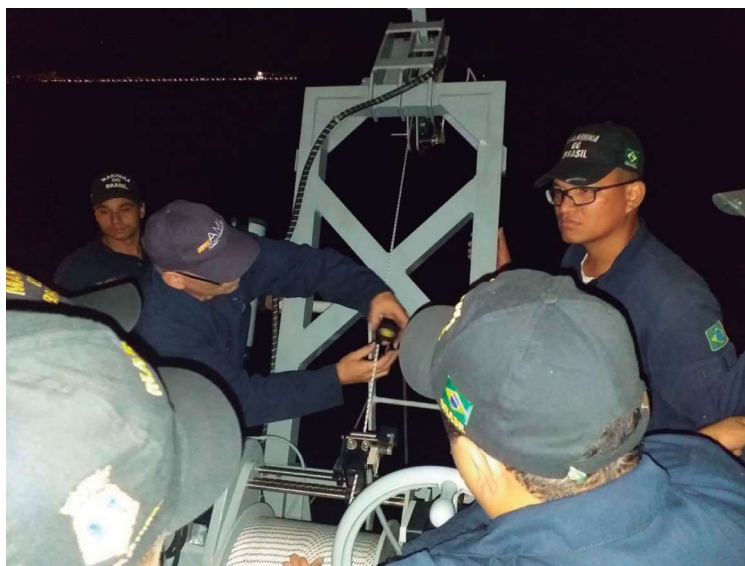
Figura 2 – Montagem do sensor no guincho do MPV 30-350
