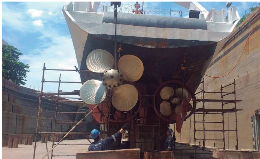
Figura 6 – Montagem da linha de eixo
