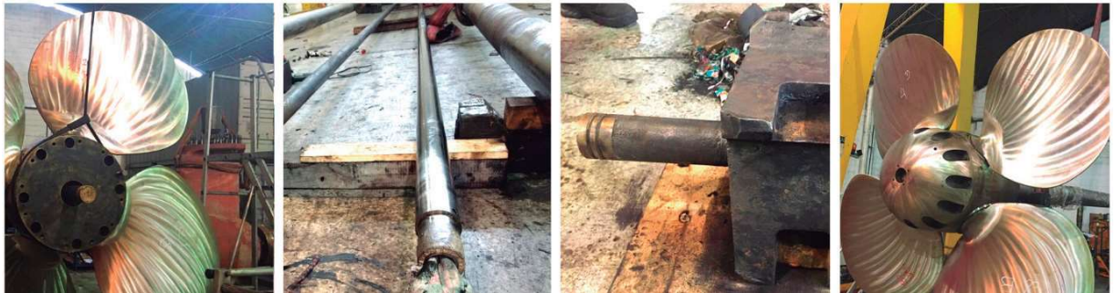
Figura 5 – Montagem da linha de eixo
