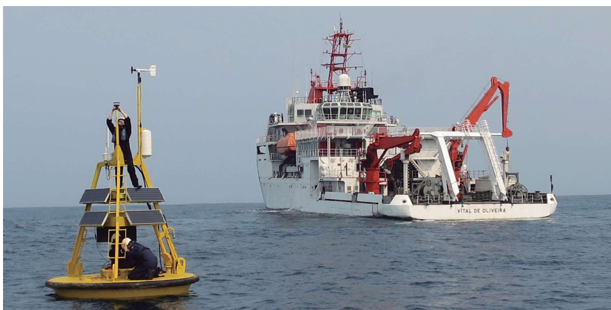
Figura 3 – Lançamento da boia meteoceanográfica “Itaguaí” pertencente ao Programa Nacional de Boias
