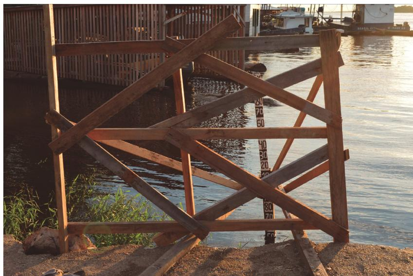
Figura 3 – Régua instalada na foz do rio Jutai. Foi arbitrado nível de 20 m para essa seção de régua e a leitura diária da cota foi feita pelo pessoal da Defesa Civil da cidade durante o período do LH
