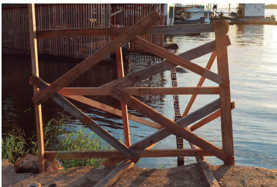
Figura 3 – Régua instalada na foz do rio Jutaí. Foi arbitrado nível de 20 m para essa seção de régua e a leitura diária da cota foi feita pelo pessoal da Defesa Civil da cidade durante o período do LH
