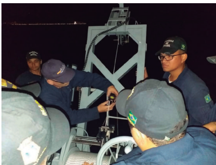
Figura 2 – Montagem do sensor no guincho do MPV 30-350
