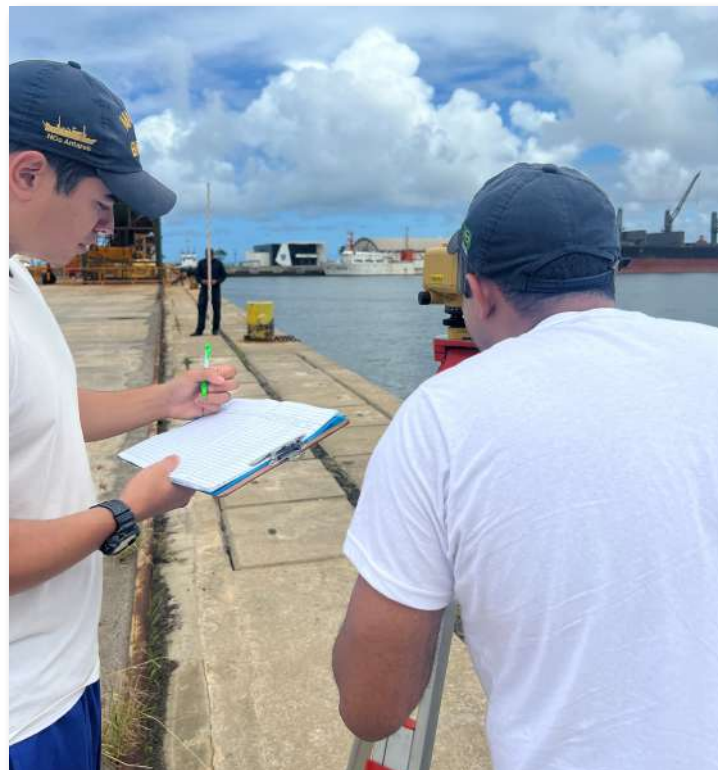
Figura 4 – Militares realizando nivelamento geométrico
