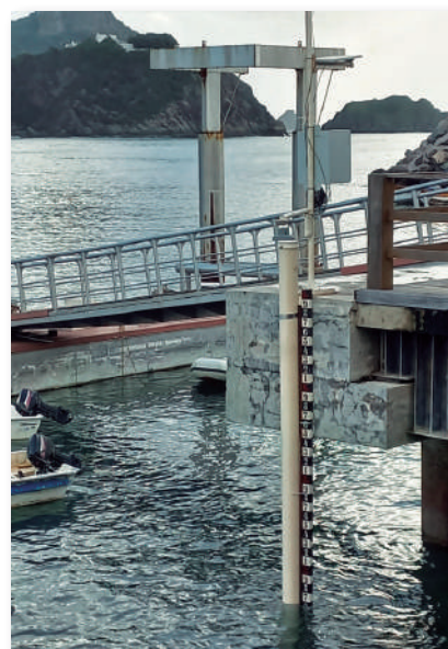
Figura 4 – Régua instalada na parte externa do cais
