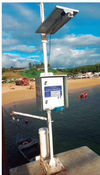
Figura 3 – Estrutura do marégrafo
