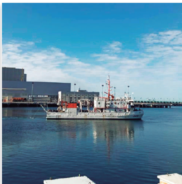
Figura 3 – Navio rebocando um sonar de varredura lateral na bacia de manobra da BSIM
