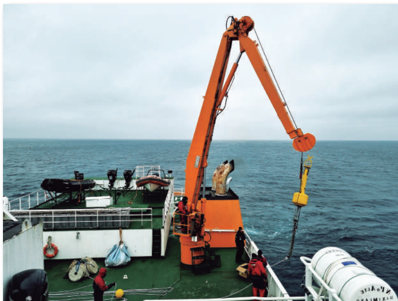
Figura 2 – Fundeio de boia meteoceanográfica nas proximidades da Península Potter
