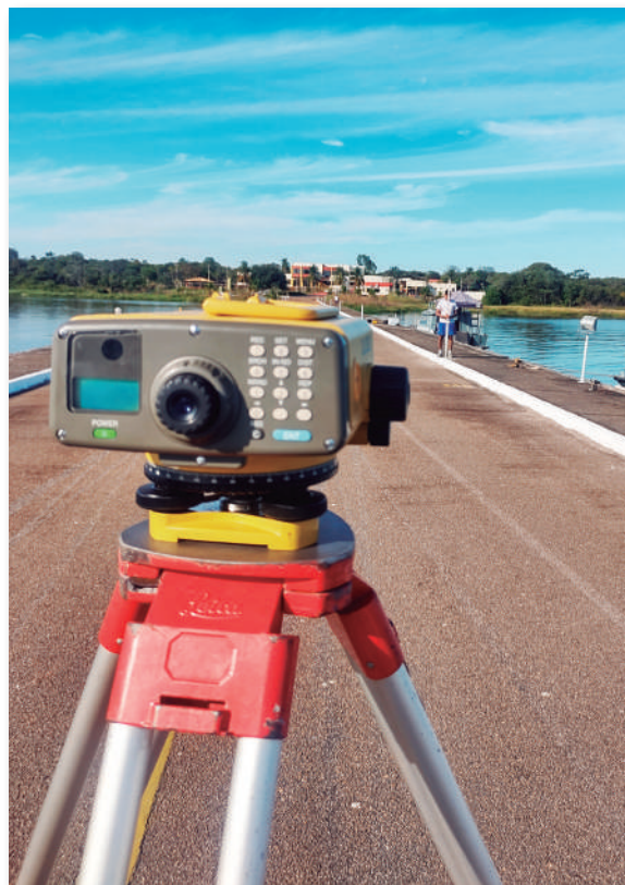
Figura 4 – Atividades de nivelamento geométrico na Capitania Fluvial do Araguaia-Tocantins (CFAT)
