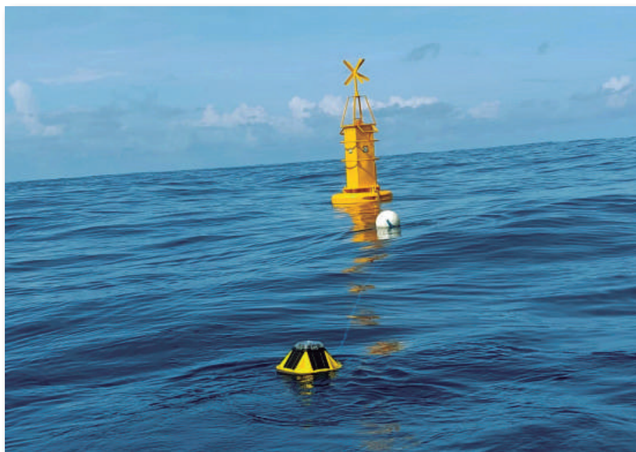
Figura 2 – Lançamento de boia especial ( Spotter V2 )
