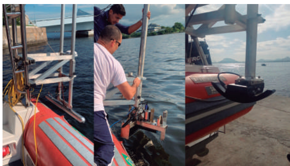
Figura 2 – Configuração dos sensores no VSNT-e, respectivamente da esquerda para direita. SVL Edgtech 4125i, R2Sonic 2024 e WingHead i77h
