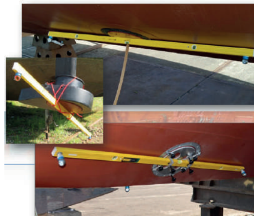
Figura 6 – Exemplo de arranjo para medição de alinhamento de transdutor. (Fonte: OVERATH & SAND, 2017)
