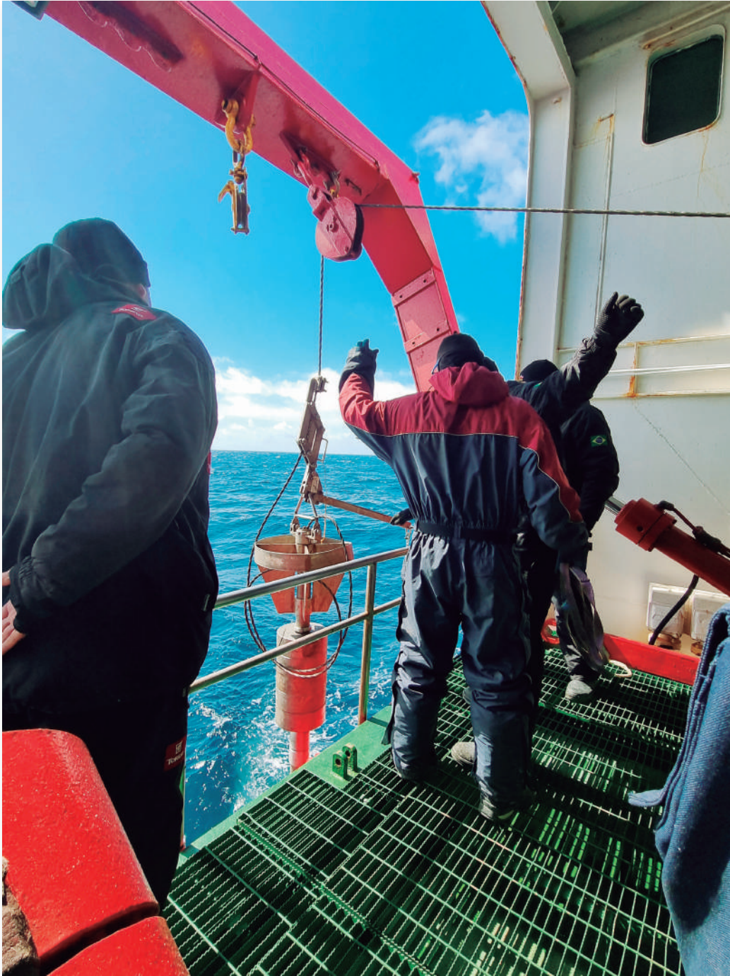
Figura 4 – Coleta geológica com o Piston Core no Estreito de Bransfield
