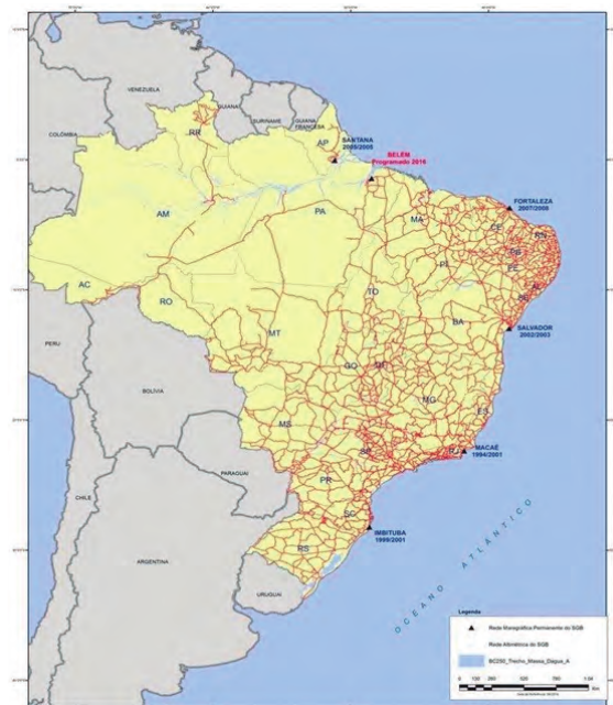
Figura 4 – Rede Altimétrica de Alta Precisão e a Rede Maregráfica Permanente para Geodésia (RMPG) do IBGE (Fonte: IBGE, 2018)
