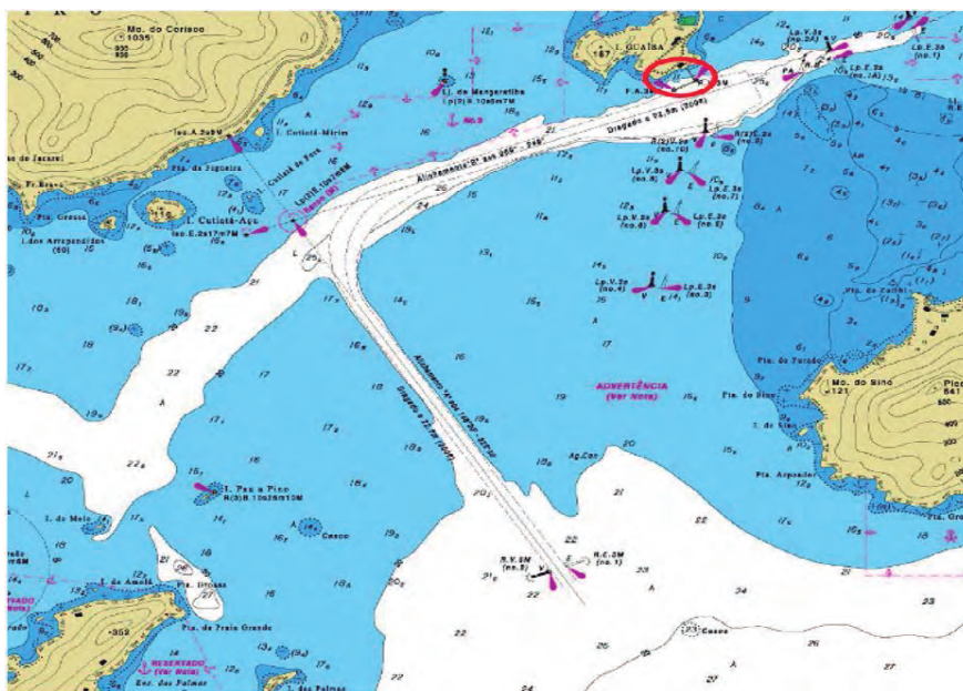
Figura 2 – Extrato da Carta Náutica 1607 demonstrando o canal de entrada ao Terminal de Uso Privado (TUP) da Ilha Guaíba, o qual é delimitado, na imagem, com um círculo na cor vermelha. (Fonte: Diretoria de Hidrografia e Navegação, 2019)
