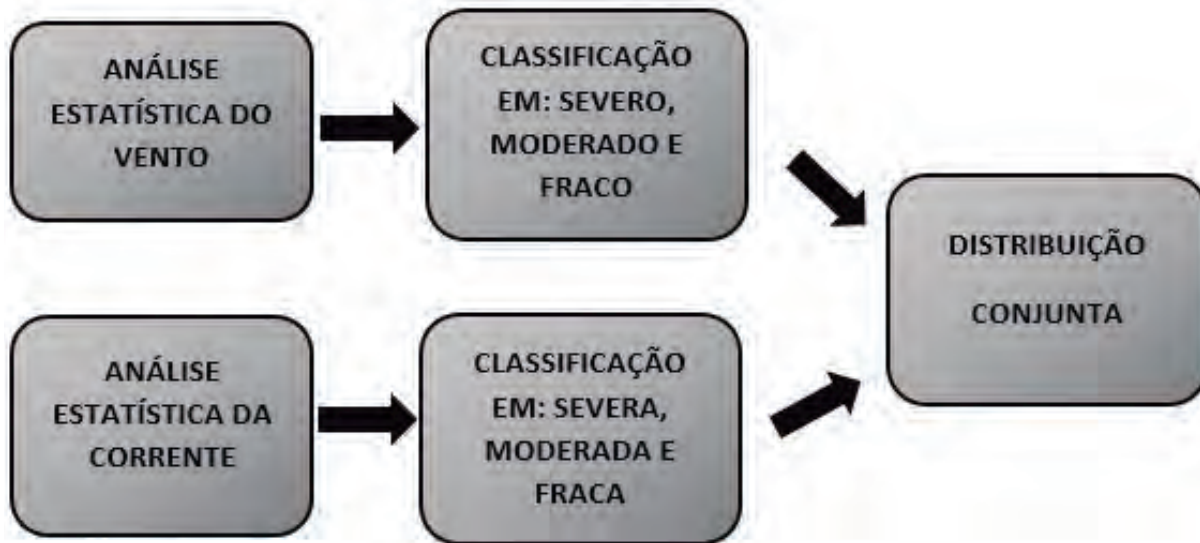
Figura 6 – Fluxograma indicando as etapas realizadas para obtenção da combinação de cenários de corrente e vento, e as respectivas probabilidades a serem utilizadas no simulador.
