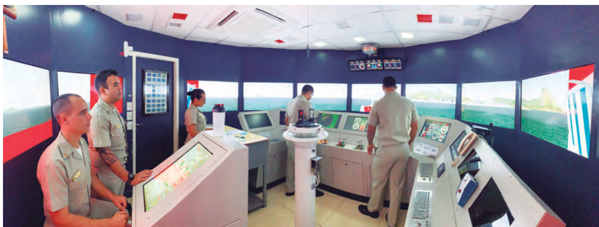
Figura 3 – Treinamento com alunos do CIAGA simulando a navegação no canal de entrada do Rio de Janeiro, utilizando o simulador desenvolvido pelo CASNAV. Fonte: CASNAV.
