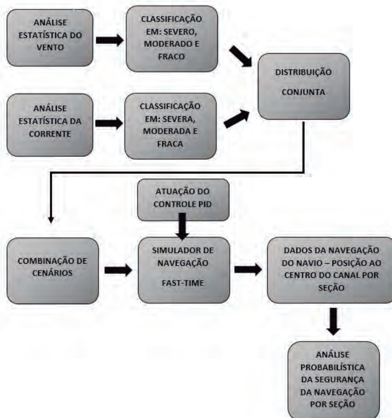
Figura 9 – Fluxograma contendo todas as etapas metodológicas percorridas no estudo visando à realização da análise probabilística da segurança da navegação.
