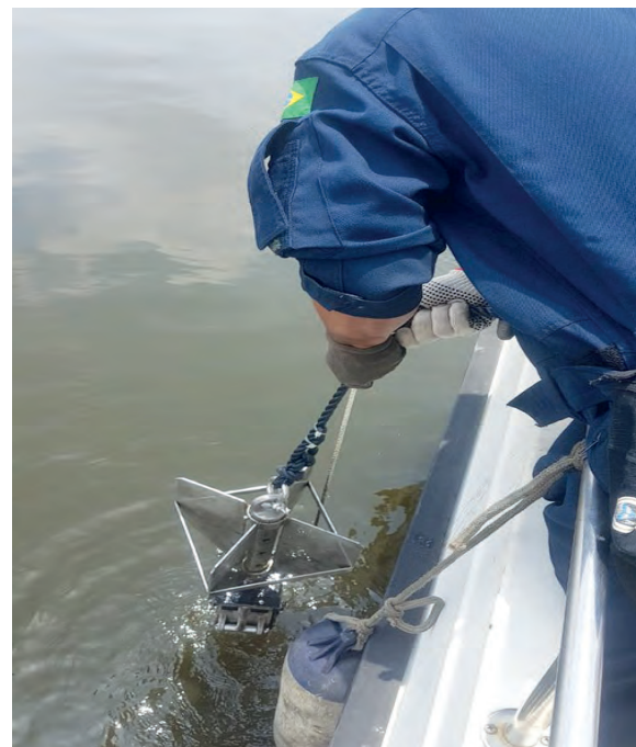
Figura 3 – Realização de lançamento do Sound Velocity Profile (SVP)
