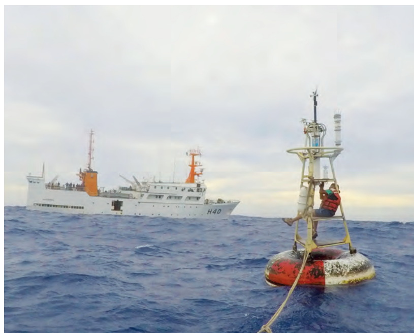
Figura 3 – Inspeção e manutenção de boia do Projeto PIRATA
