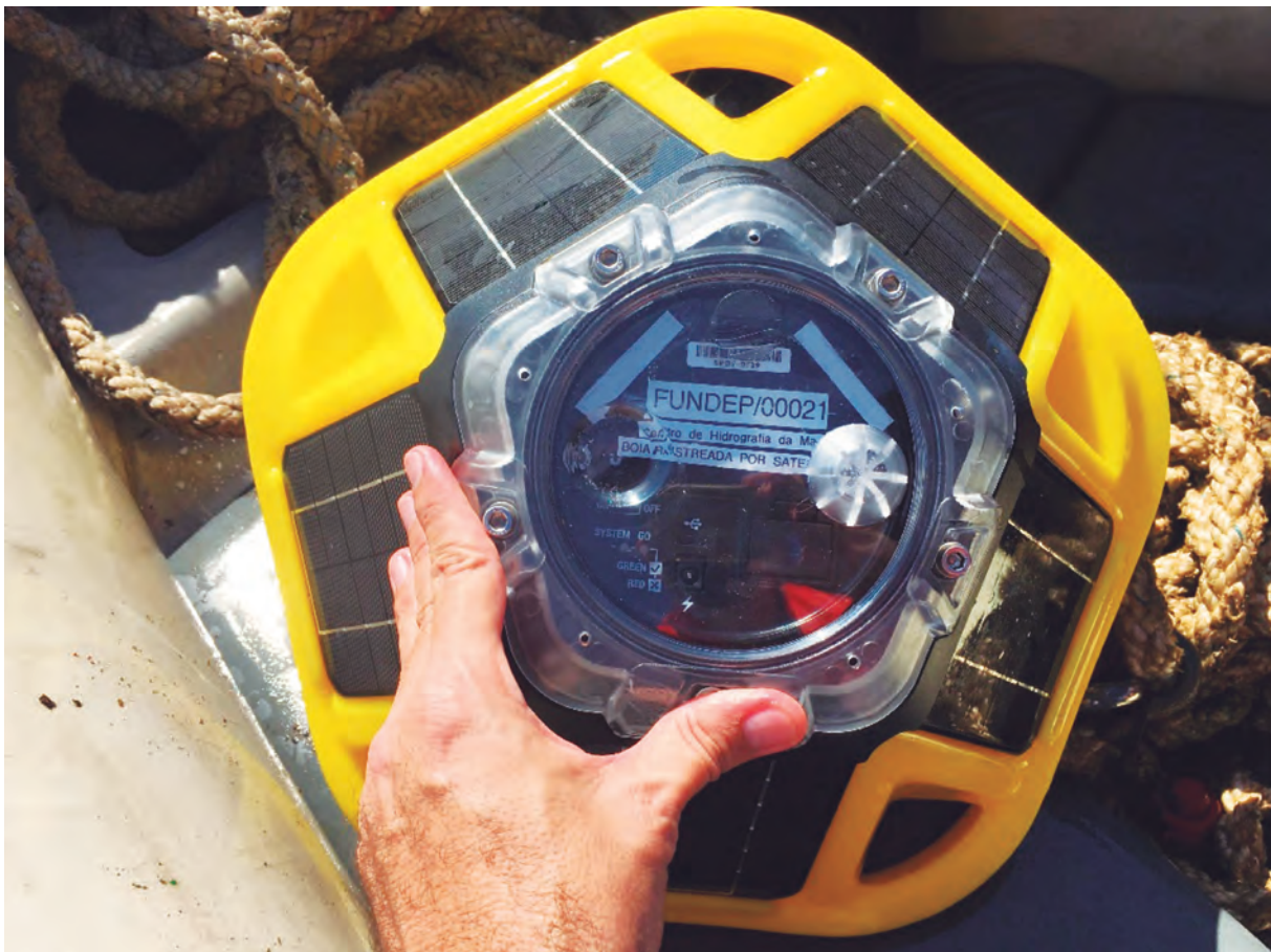
Figura 2 – Vista da boia Spotter V2 e suas dimensões (Largura: 42 cm; Altura: 31 cm; e Peso: 5,4 kg).
