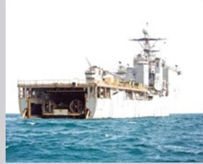
Figura 4: Um Landing Craft Air Cushion (LCAC) situa-se na doca alagável interna do navio ancoradouro USS Pearl Harbor (LSD 53) durante as operações de descarga. O LCAC permite que o Corpo de Fuzileiros Navais realize operações de desembarque em uma ampla gama de praias e no exterior Fonte: US Navy, por Jason Behnke
