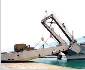
Figura 3: O Tank Landing Ship (LST) e USS Frederick (LST 1184) da Marinha dos EUA, com uma rampa em arco para embarcar os Marines e equipamentos, em 29 de março de 1996. Os LSTs dos EUA foram usados para transportar tanques de terra, veículos anfíbios e outros materiais circulantes em operações de assalto anfíbio. Fonte: US Navy
