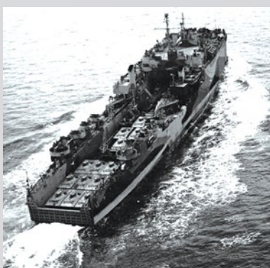
Figura 2: A classe Ashland LSD USS Oak Hill (LSD 7), em 21 de abril de 1944, ao longo da costa da Califórnia, a caminho de Pearl Harbor, com dois Flotilla 13 LCTs a bordo. LCT 984 e 982 LCT são carregados de popa à proa na doca alagável interna do Oak Hill, acompanhado de numerosos LVTS. A classe Ashland foi a primeira classe de navios anfíbio de doca, com doca alagável interna, permitindo-lhes flutuar embarcações de desembarque e veículos anfíbios. Fonte: US Navy
