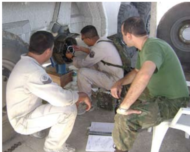
Foto 1 - Pessoal da EqMvMnt-Haiti repara vazamento no cubo de roda de uma Vtr PIRANHA IIIC. Fonte: autor, 2010.
