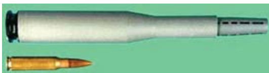
Figura 6 – Cartucho Steyr 15.2mm comparado ao cartucho 7.62mm. NATO (.308 Winchester). Fonte: Modern Firearms, 2010a.
