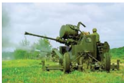
Foto 1. Canhão Automático Antiaéreo 40mm L/70 Bofi-R
