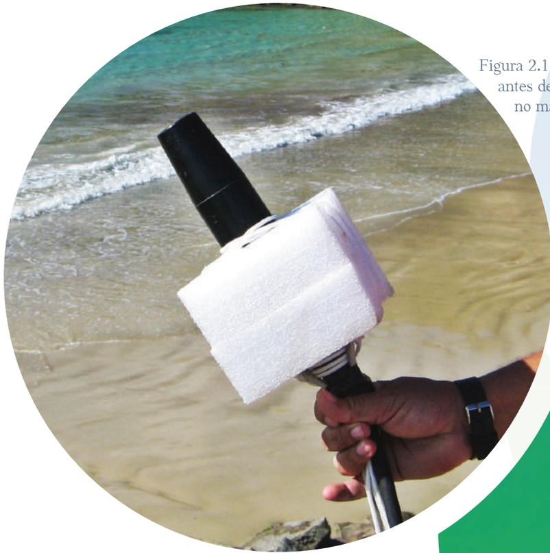
Figura 2.1: Hidrofone antes de ser colocado no mar.
