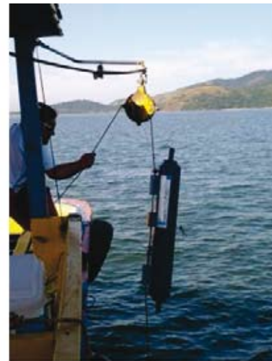
Figura 2: Técnico realizando a coleta de água com garrafa oceanográfica de Van Dorn.
