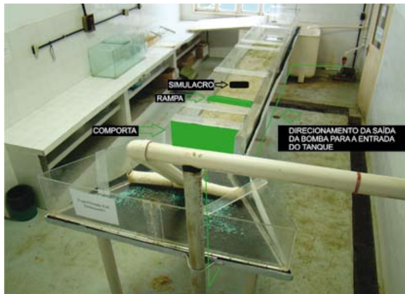
Figura 2: Esquema das modificações a serem realizadas no tanque Flume do IEAPM. Modificado de: Amarildo Alves da Silva, 2013.
