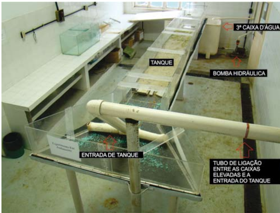
Figura 1: Esquema do tanque Flume original do IEAPM. Mo- dificado de: Amarildo Al- ves da Silva, 2013.
