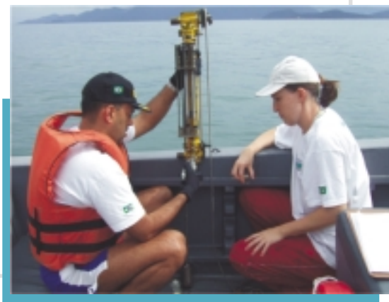
Coleta de água do mar com garrafa Nansen de 1,5 l, com leitura da temperatura no termômetro de inversão, in loco.
