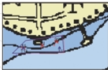
(B) Detalhe da área a ser dragada no cais de Itacuruçá. Pontos de coletas dos sedimentos superficiais (X) e dos testemunhos de sondagem (A). (Extrato da Carta Náutica 1607 de 2000).
