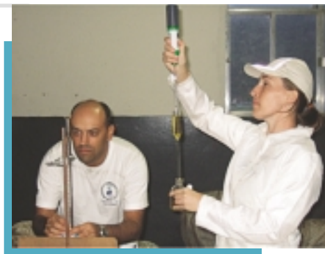
Titulação do O.D. pelo método de Winkler no laboratório.
