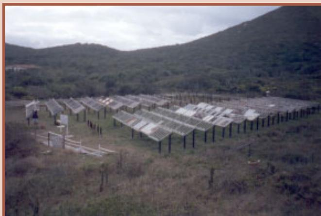
Painéis para corpos de prova
