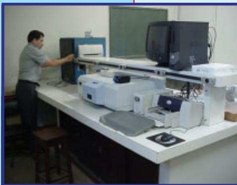
Espectrofluorímetro com célula de fluxo para trabalhar nos modos fluorescência, fosforescência, quimioluminescência e bioluminescência;
