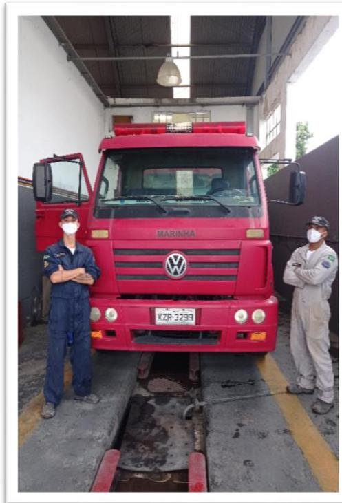
A capacidade de armazenamento do caminhão de bombeiro é de 6.000 litros de água potável e o caminhão opera com duas bombas com pressão de descarga de 750 galões por minuto (GPM), mantendo 02 linhas de mangueiras para o combate a incêndio.
