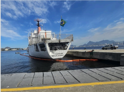
Lançamento de barreira de contenção no NHoFAlteGAranha
