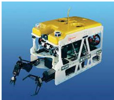
FIGURA 2 – Veículo de Operação Remota de Intervenção ou Intervention Remotely Operated Vehicle (iROV)
