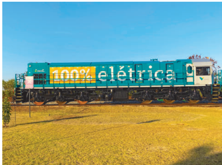
Locomotiva 100% elétrica da Vale, banco de baterias até 2,4 MWh. Operação 24 horas sem recarga.
