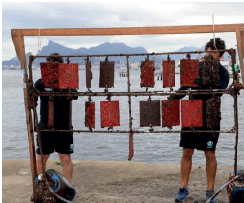
Testes com tintas anti-incrustantes
