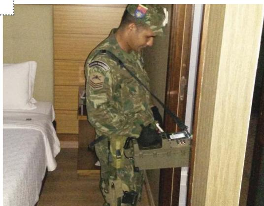
Figura 5: Detector e Identificador radiológico Spir Id .....
