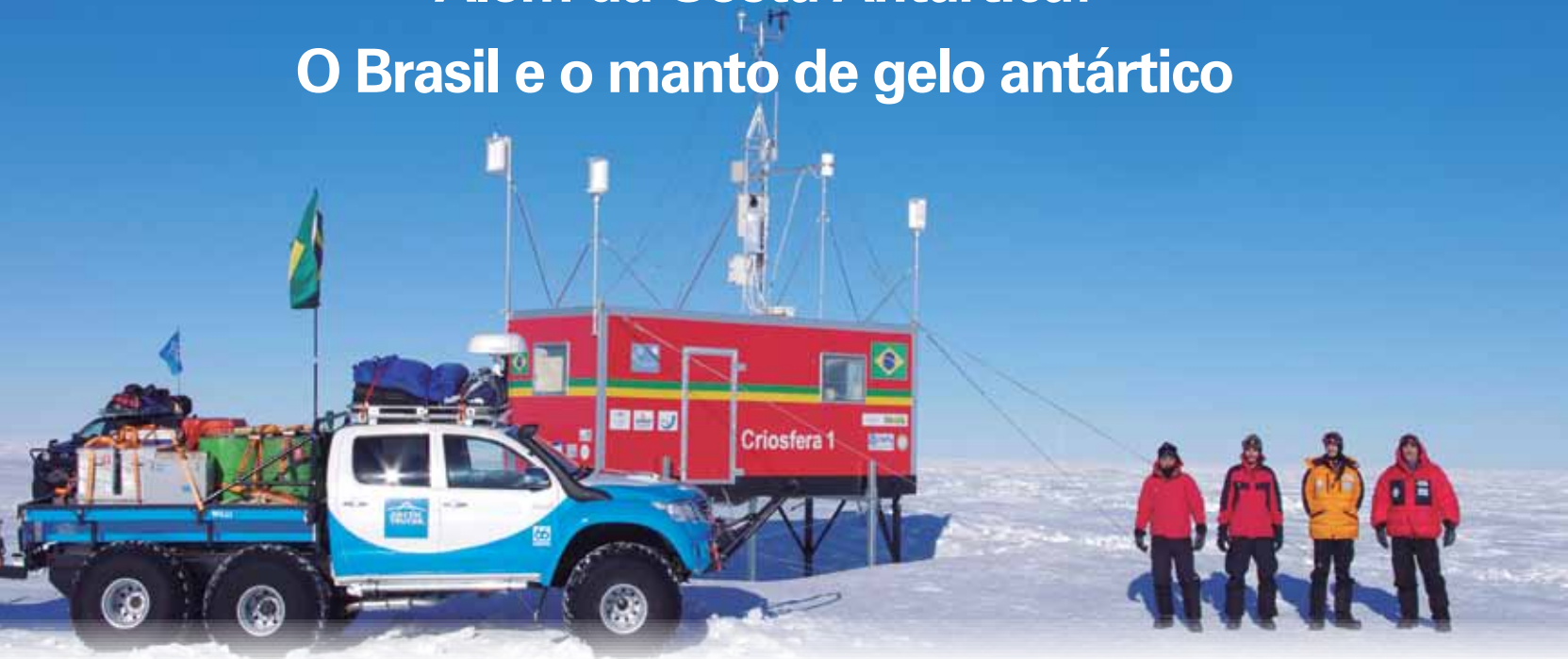
Figura 2 - A equipe do INCT da Criosfera que realizou uma travessia de mais de 1400 km do manto de gelo da Antártica Ocidental usando veículos Toyota Hilux modificados (com três eixos) quando da passagem pelo módulo automatizado Criosfera 1. Daí a equipe seguiu viagem para o norte até o futuro local do módulo Criosfera 2 (a ser instalado aproximadamente a 80°S, 94°W no verão de 2015/2016, ponto verde na Figura 1).
