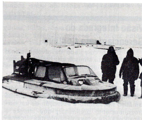
O "hoverlight" da Companhia Penha de Máquinas Agrícolas em teste sobre a neve.
