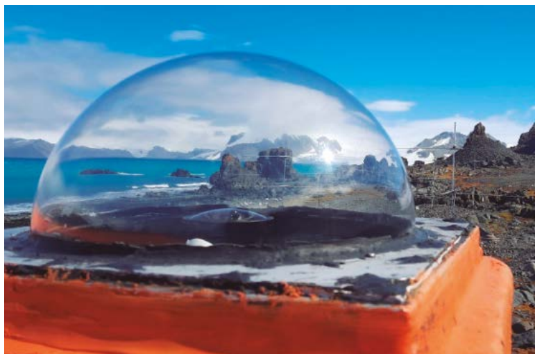
Sistema imageador da aeroluminescência ou Airglow do inglês instalado no módulo de Punta Plaza, próximo da EACF, que observa fenômenos na Mesosfera e Ionosfera (ondas atmosféricas, distúrbios ionosféricos propagantes e possíveis arcos de Aurora durante tempestades solares).
