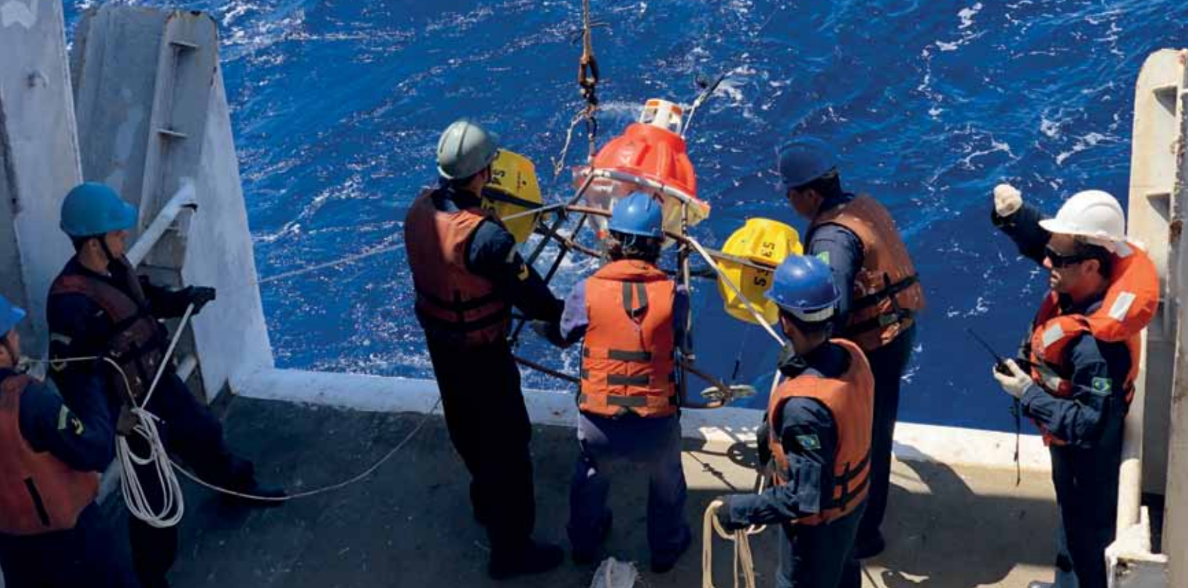
Dispositivos C-PIS que foram lançados na Dorsal Meso Oceânica e canal Hunter. Equipamentos ancorados a quase 4 km de profundidade detectarão variações de salinidade, temperatura e velocidade das correntes marítimas (Foto: 1°Ten Klinger)
