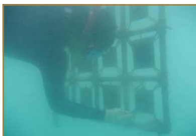
Placas submersas para medir a corrosão. Essa metodologia será utilizada no projeto desenvolvido na Antártica.
