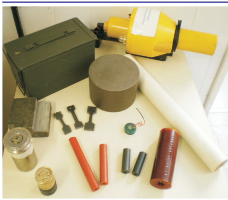
Materiais energéticos em diversas formas, como aplicado, na geometria de corpos de prova, e fabricados em diferentes formulações.
