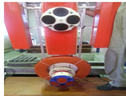
Figura 1 - Montagem solidária dos ADCPs do IPqM e da Teledyne RDI num único conjunto estrutural, para a realização de testes na Baía de Guanabara - DepCMR.
