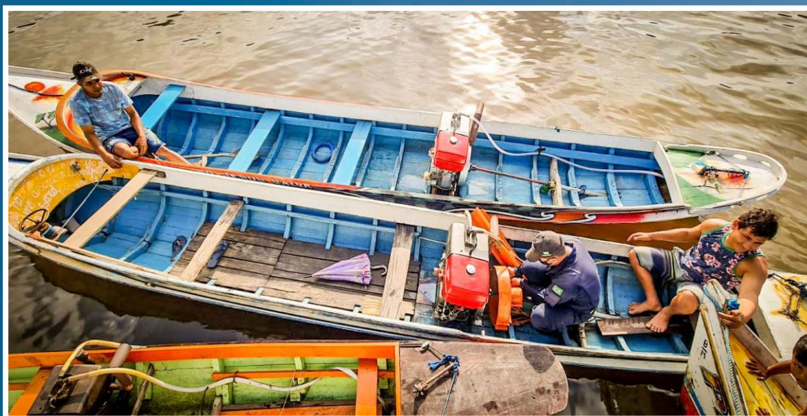
Militar da Marinha instala cobertura de eixo de motor de embarcação de ribeirinho
