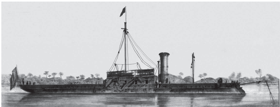
Figura 2 – “A Corveta encouraçada Brazil depois do combate com as baterias das barrancas de Curupaity, no Paraguai, no dia 22 de Setembro de 1866”, segundo R. M. C. Lith. por Anon. da off. de Pelvilian. S. d. (1866). O Couraçado Brasil , era um dos navios com “sistema” de casamata, sendo representado após a intensa troca de fogos com as baterias de Curupaity durante a fracassada operação militar contra aquela fortificação, em setembro de 1866. Classificado, na época, como corveta-encouraçada, a gravura de autor anônimo da Oficina de Litografia de Pelvilain mostra os inúmeros impactos que o navio recebeu a sua blindagem. (Fonte: Biblioteca Nacional).
