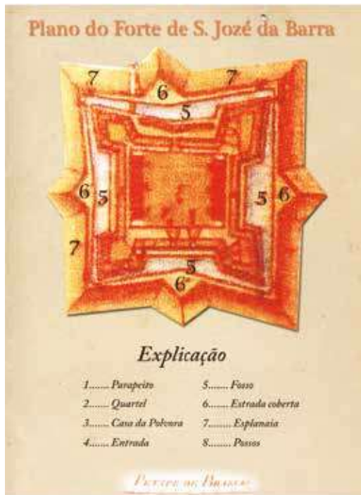
Figura 10: Planta do Forte de São José da Barra, ejecutada pelo Capitán Ingeniero João André Eschwel, no ano de 1756.
