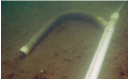
Figura 11 – Conexão em Y da sugadora
