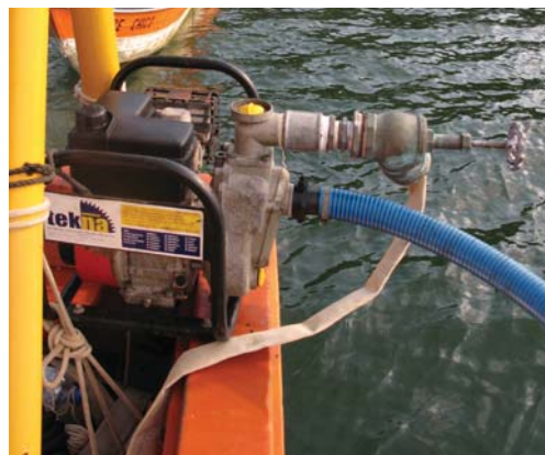
Figura 10 – Motobomba acoplada à embarcação. (Foto: Alvanir, 2008)
