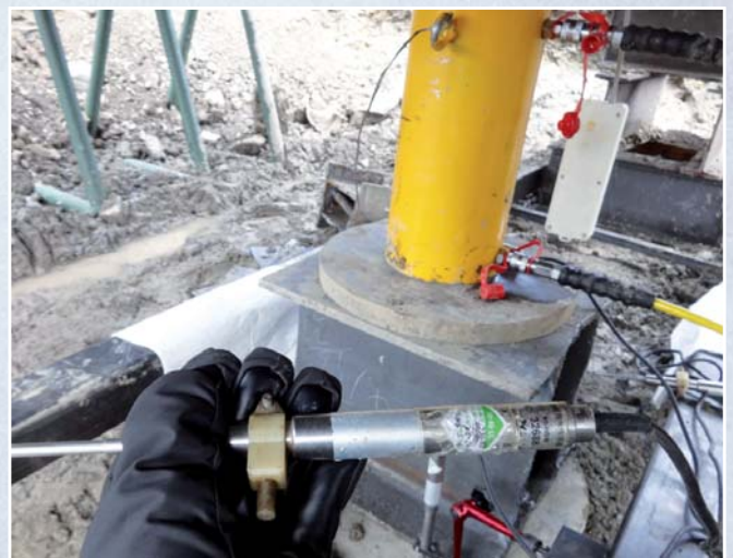
Foto 8 - Extensômetro e macaco hidráulico.
