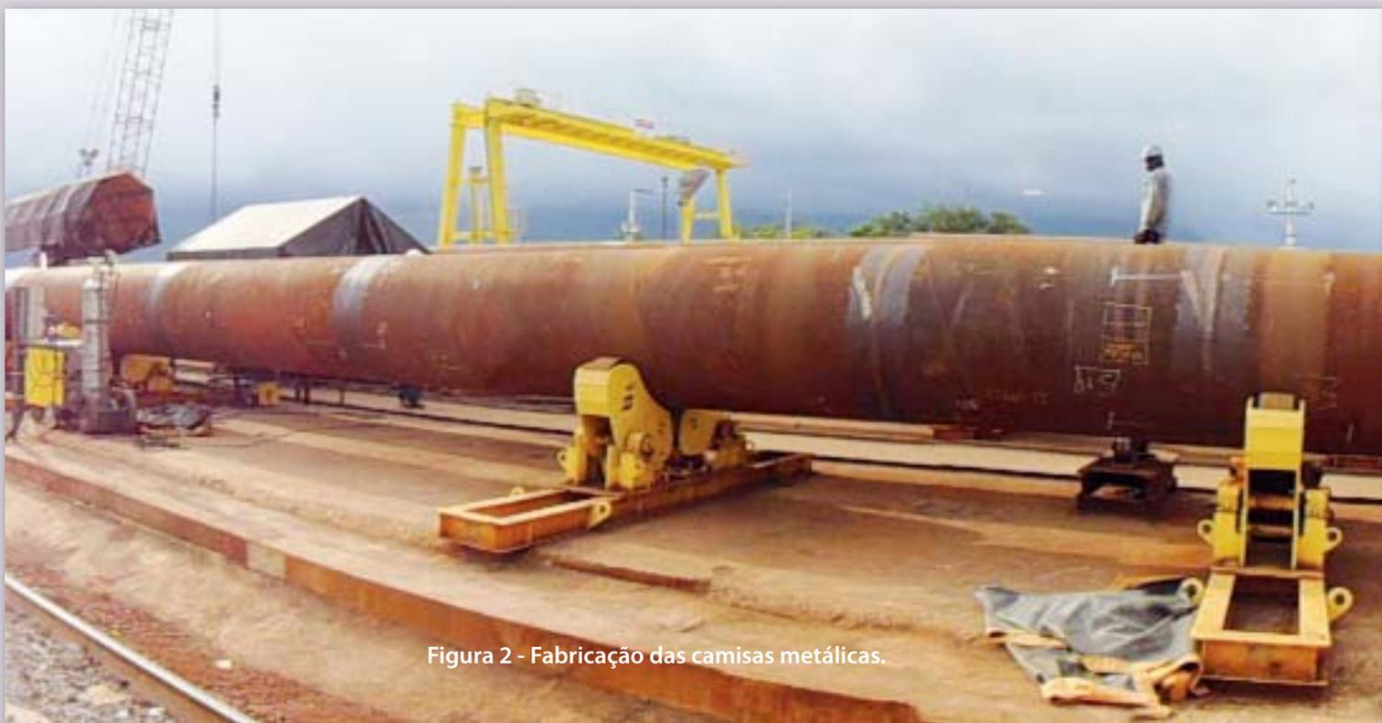
Figura 2 - Fabricação das camisas metálicas.
