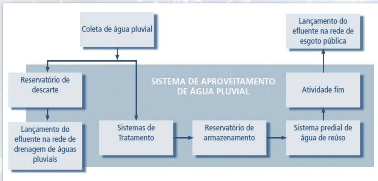
Figura 2 – Fluxograma do sistema de aproveitamento de águas pluviais.
