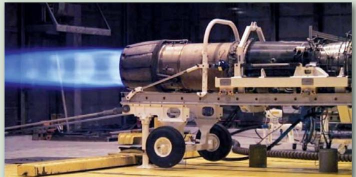
Figura 1 – Motor F404 de caça F/A-18 em funcionamento com biocombustíveis no centro de testes em Patuxent River, Maryland (Fonte: *US Navy*, 2010).
