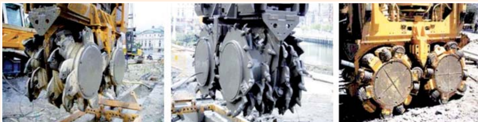
Figura 4 – Tipos de Rodas de corte da hidrofresa
