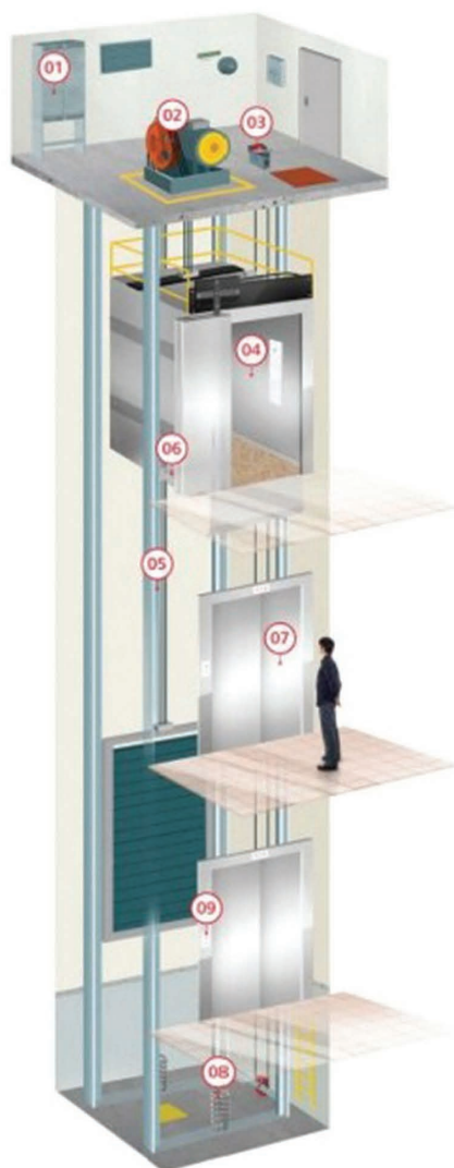
Figura 1 - Desenho esquemático de uma instalação de elevadores com casa de máquina.
