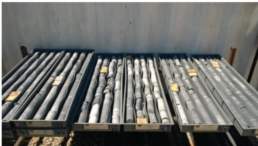
Figura 01 – Testemunhos de rocha obtidos em sondagens rotativas.
