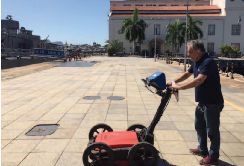
Execução de levantamento geofísico com Georadar (GPR). Fonte: ScanGEO
