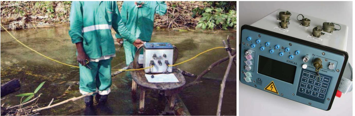
Figuras 03 e 04 – Resistivímetro da SYSCAL PRO, com aplicação em campo.
