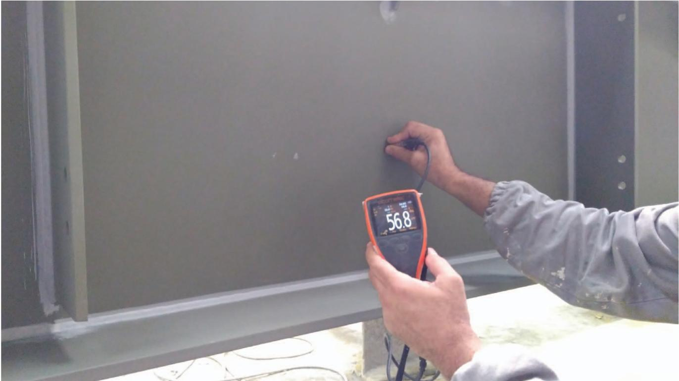
*Medidor de espessura.*
