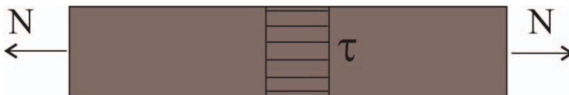
Figura 6 – Distribuição de tensão em barra tracionada.
