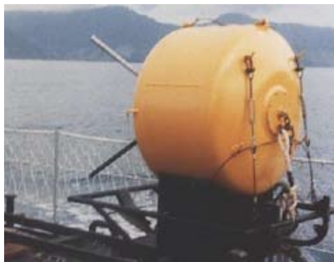
Mina de fundo e contato desenvolvida pelo IPQM
