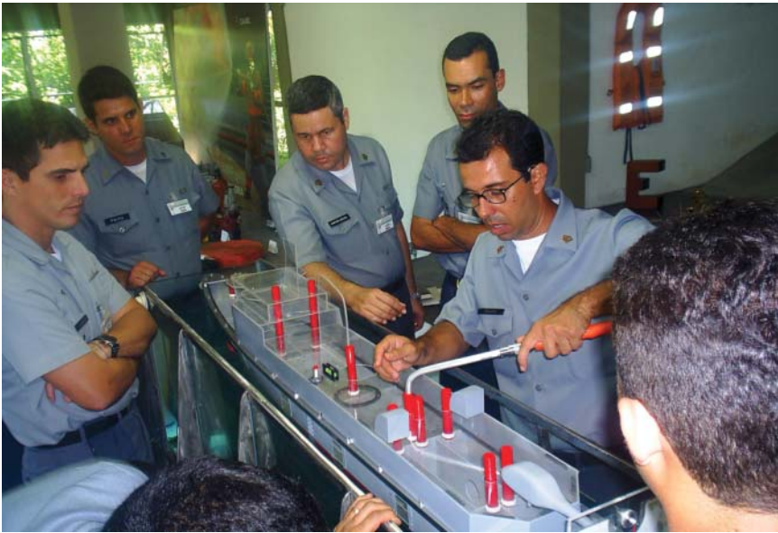
Simulação da condição de estabilidade após avarias
