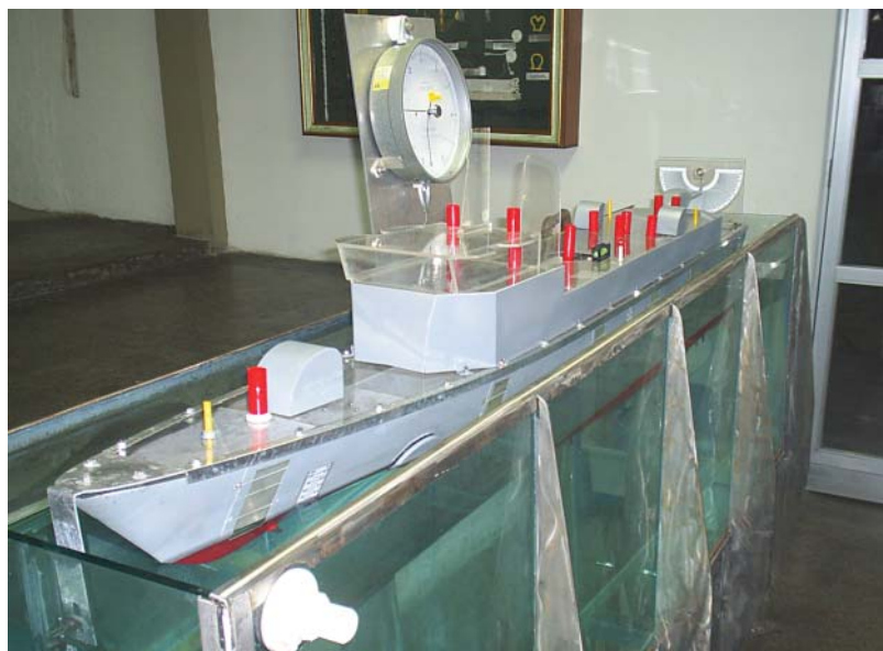
Modelo de estabilidade em escala 1:50 de uma corveta
