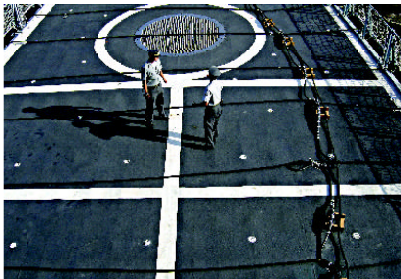
Aspecto da amarração dos cabos de desmagnetização.
