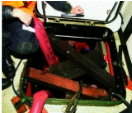
Vista interna do navio com os esforços feitos para conter os alagamentos.
