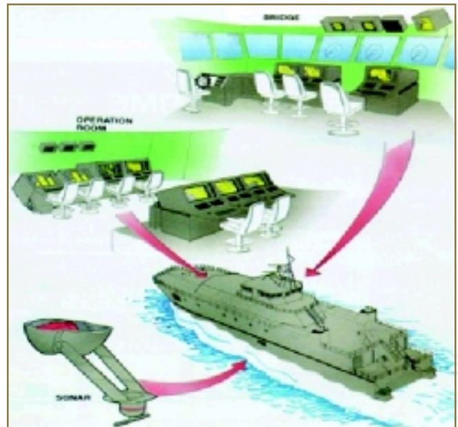
O sistema integra os sensores, a manobra e os equipamentos de CMM
