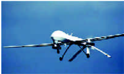
Fig. 5 - UAV Predator. Notem os sensores e os mísseis Hellfire sob as asas, um início de uma nova era – UCAV (Unmanned Combat Aerial Vehicle).
