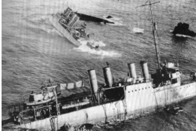
O S.P. LEE EM PRIMEIRO PLANO, A FOTO MOSTRA COMO AS OBRAS VIVAS FORAM RASGADAS LOGO AVANTE DO REPARO DE TORPEDO DE BORESTE. O NICHOLAS APARECE EM SEGUNDO PLANO, PARTIDO EM DOIS.
