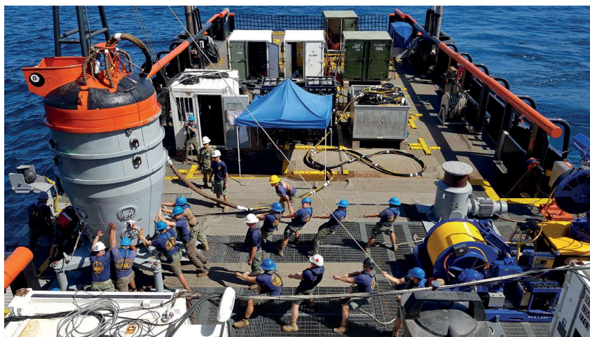
Figura 2 - Convés do HOS Dominator, durante manobras com o Sino de Resgate, no dia 19 de setembro de 2018. É possível observar a disposição modular do sistema.
