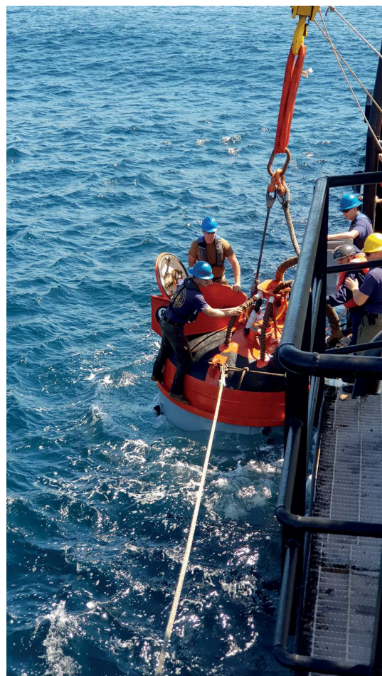
Figura 3 - Operação do SRC, a bordo do HOS Dominator, no dia 19 de setembro de 2018. É possível observar na foto o momento do embarque de pessoal antes da descida do Sino.
