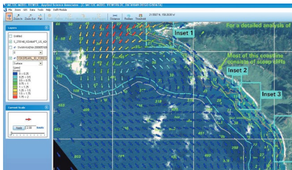
Figura 4: Exemplo de modelo utilizado na Marinha dos EUA (EUA, 2010). O METOC Model Viewer (MMV) da Naval Oceanographic Office (NAVOCEANO) é usado para exibição de um arquivo com corrente de maré, camadas climatológicas e imagens georretificadas. Os limites ambientais das plataformas dos Grupos de Operações Especiais da Marinha dos EUA também podem ser plotados em um menu para uma rápida identificação de áreas de oportunidade ou de risco.
